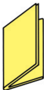
Рис. 3.2. Симметричная 2-сгибная параллельная фальцовка
