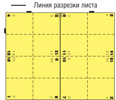
Рис. 2.17. Макет спуска на одну форму для печати с переворачиванием листа (трехсгибная перпендикулярная фальцовка, 2×16-страничные одинаковые тетради)
